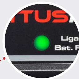
LED INDICADOR DE LIGADO/ BATERIA FRACA
